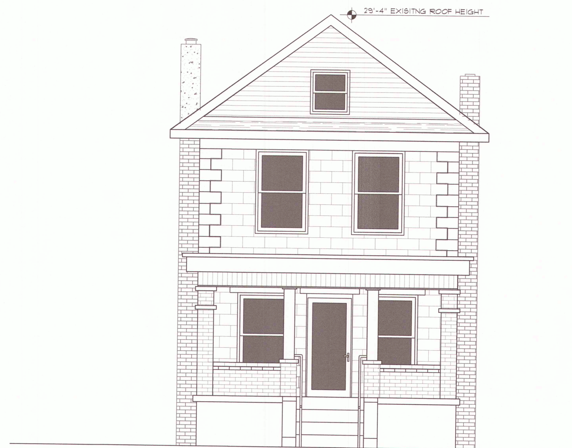
1 FRONT ELEVATION A-3 SCALE: 1/4" = 1'-0"
